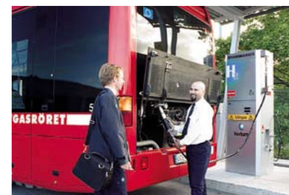
Estação de Abastecimento de Hidrogênio HySTAT™ do Projeto CUTE em Estocolmo, Suécia.
