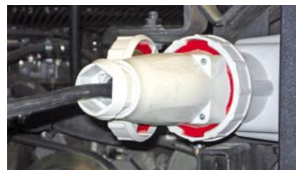
Receptáculo para recarga das baterias de alta tensão.
